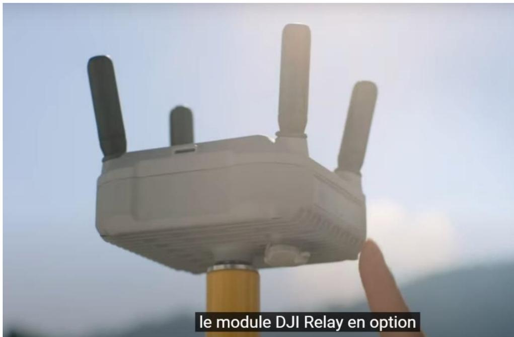
*Le Module DJI Relay, en option, permet un relais de connexion plus éloigné.*
