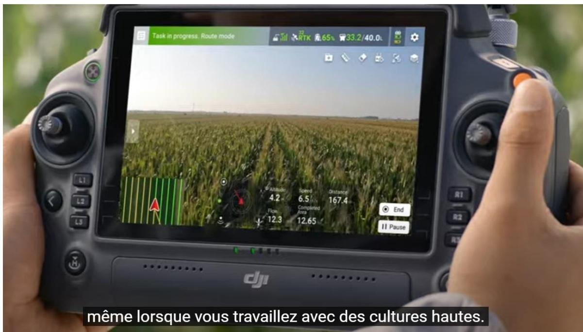
*La Camera Frontale permet d'avoir toujours une vue sur le travail en cours et la position du drone grâce à la télémétrie.*
