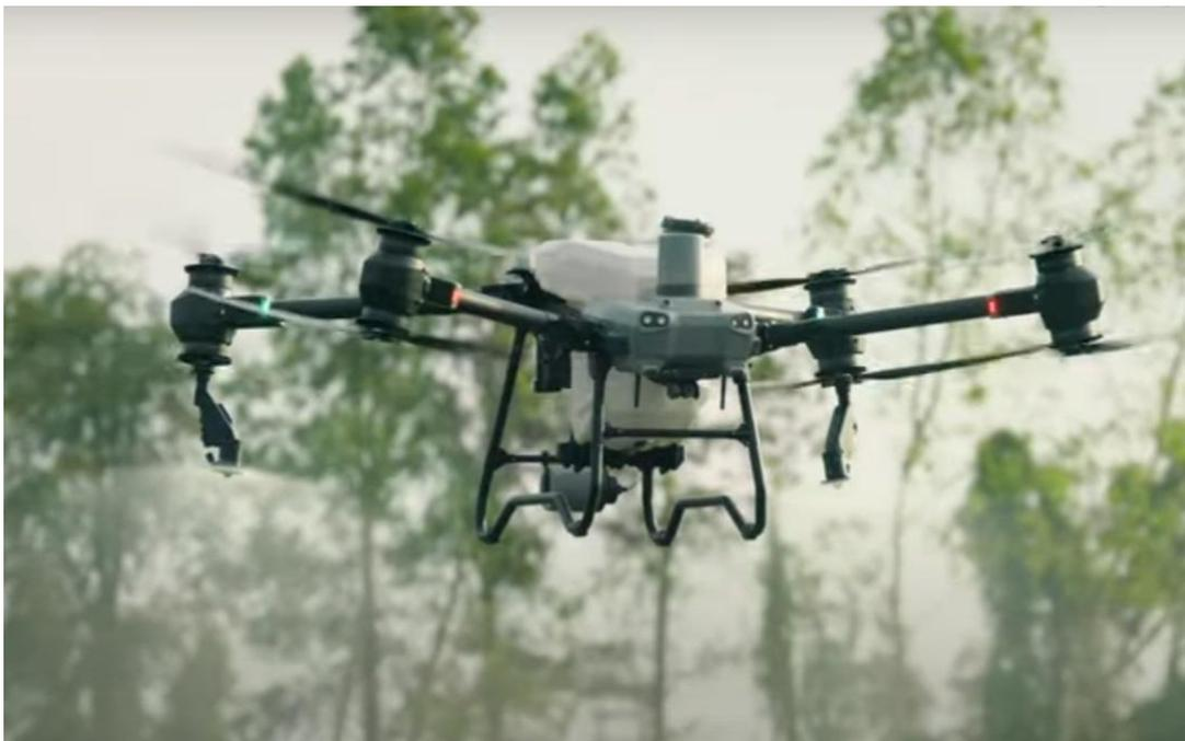
Les améliorations apportées au T50 incluent un système de transmission O3 amélioré à quatre antennes avec une portée allant jusqu'à 2 km et deux radars actifs à réseau phasé associés à des capteurs de vision binoculaires pour une détection d'obstacles et une navigation sur le terrain améliorées. Un kit de quatre arroseurs en option permet une capacité de pulvérisation accrue, particulièrement bénéfique dans les environnements de vergers denses.
