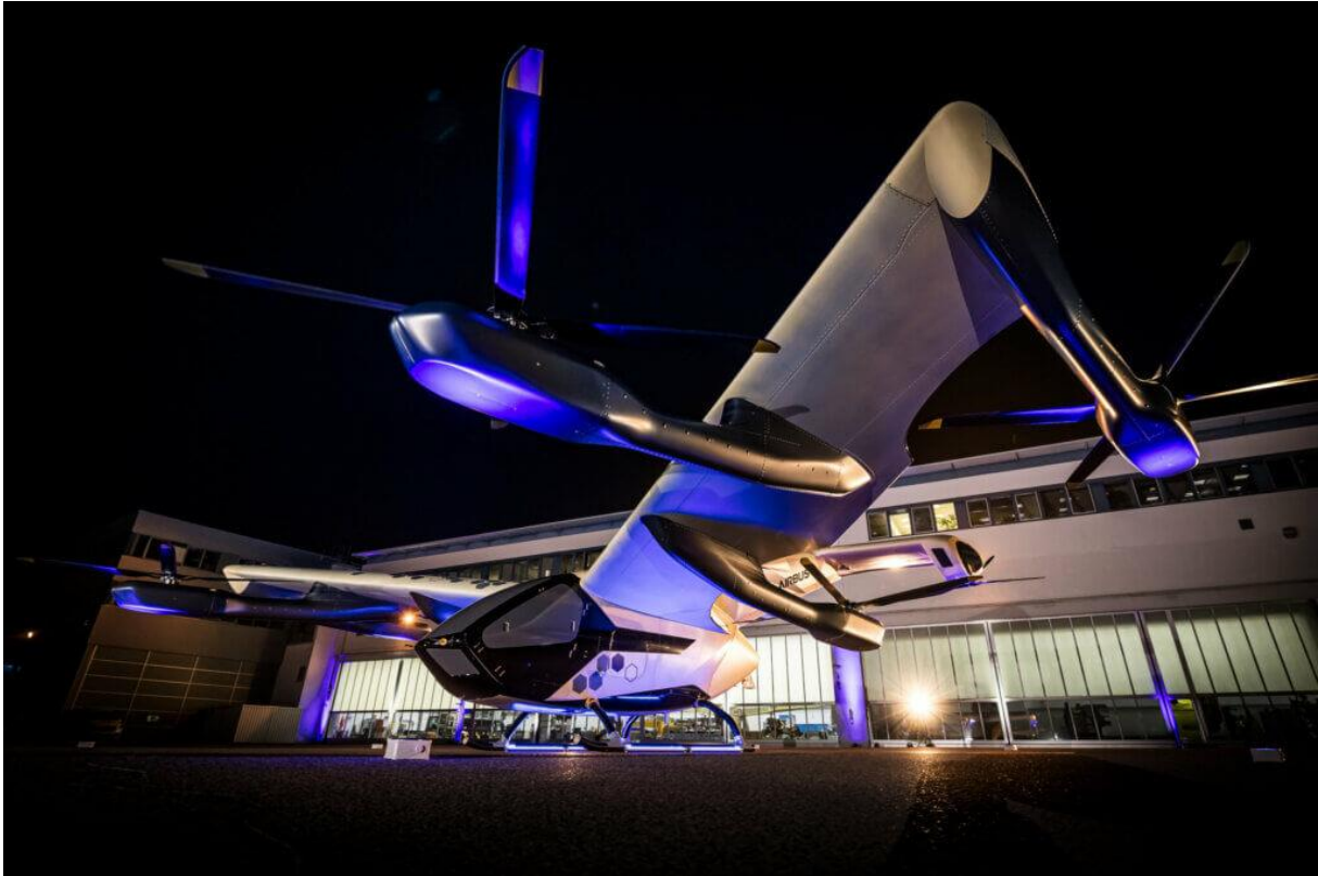
CityAirbus NextGen a une envergure d'environ 40 pieds (12 mètres) Airbus Photo
